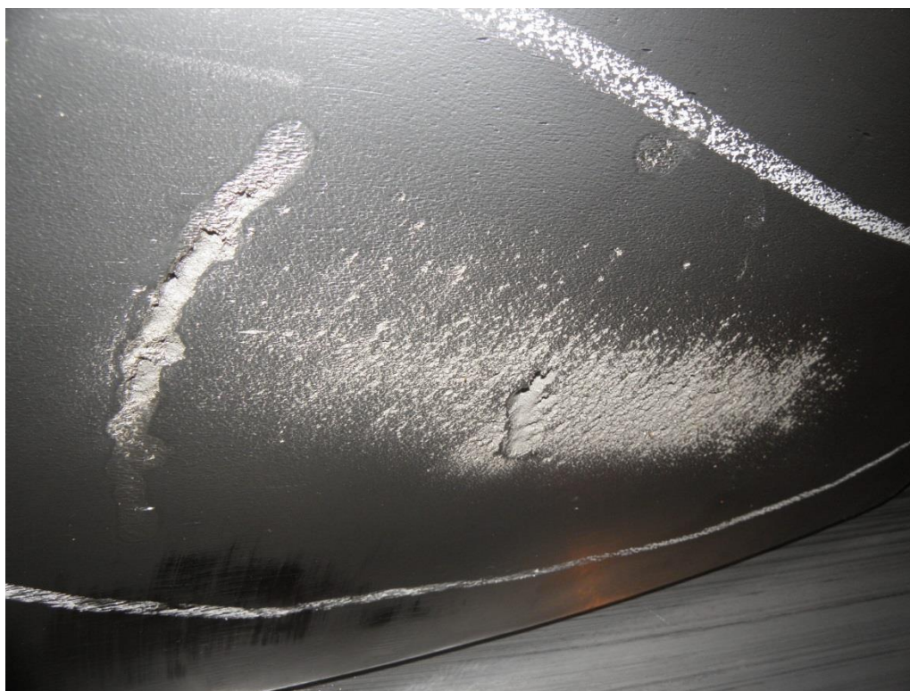
Obr. č.2 Príklad kavitácie lopatiek obežného kolesa: TG2 – kavitácia na lopate rozsah cca 3 000 mm 2 , hĺbka max. cca 10 mm
