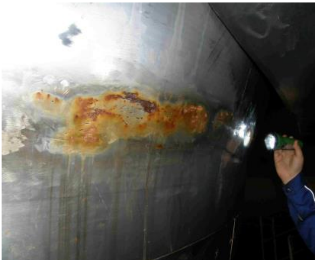
Obr.č.1 TG 5 – kavitácia na náboji obežného kolesa.
