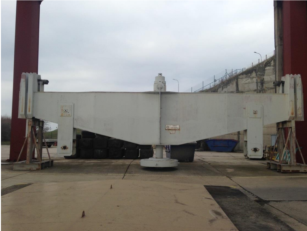
Obr. č.3 Traverza pre zavesenie rotora
