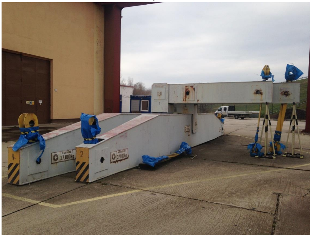
Obr. č.4 Traverzy pre zavesenie statora
